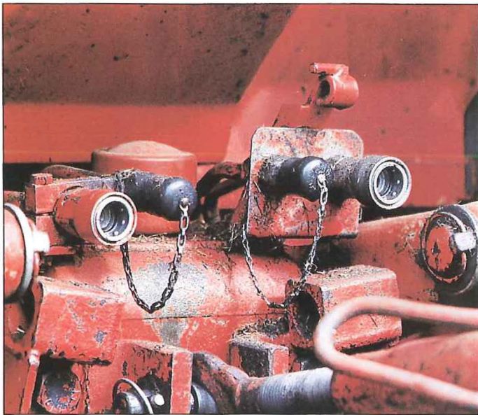
Dit is de dagelijkse praktijk voor veel snelkoppelingen: de beschermkapjes zijn kapot of verdwenen en het vuil hecht zich gemakkelijk op het vette metaal
